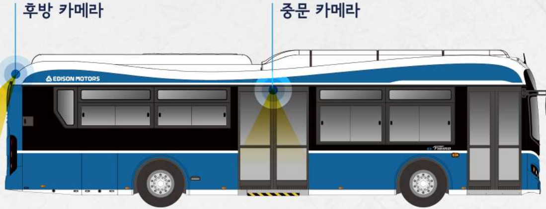
서브 디스플레이 7inch LCD Display / 탑승객 안전을 위한 상시 중문, 후방 카메라뷰
